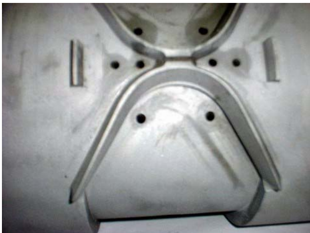
Слика 6. Ротациони нож после каљења
