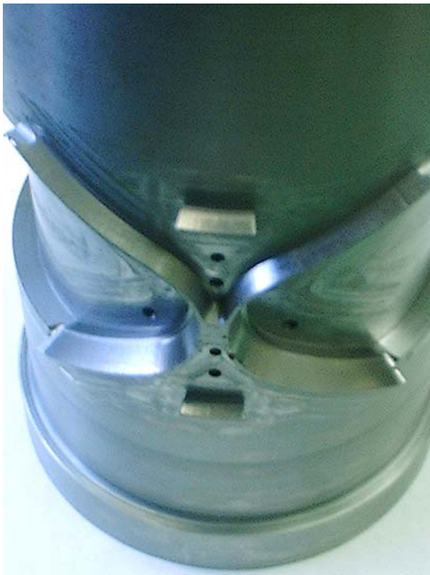
Слика 5. Ротациони нож после глодања
