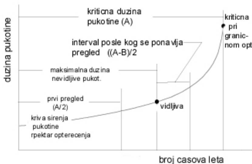
Slika 3. Kriterijumi pregleda višestruko opterećenih delova
