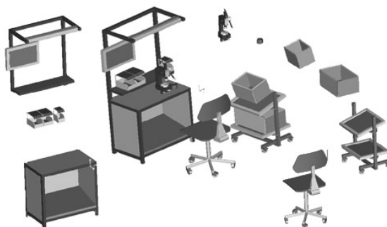
Slika 3. Ručno-mehanizovano radno mesto projektovano primenom modularnog koncepta
