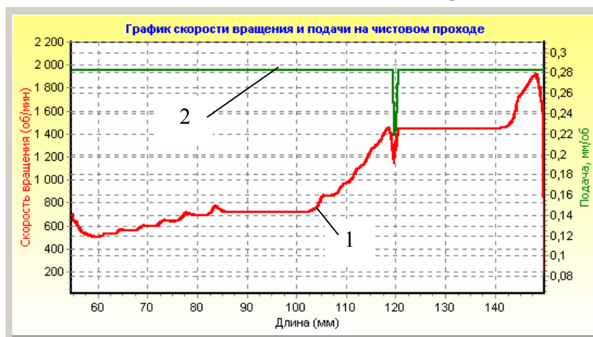
Рис.5. Оптимальное управление режимами резания на чистовом проходе
