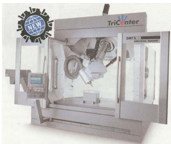
Sl. 4. Obradni centar GILDEMEISTER tip TriCentar sa paralelnom kinematikom za brzu orijentaciju i pozicioniranje radnog vretena
