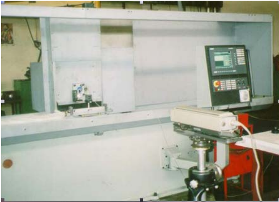
Slika 5. Primer merenja tačnosti pozicioniranja u pravcu "Z" ose
