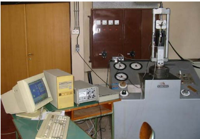
Slika 3 - Eksperimentalna oprema za eksperiment vučenja Slika 4 - Matrica i držač na priboru za zatezanje
