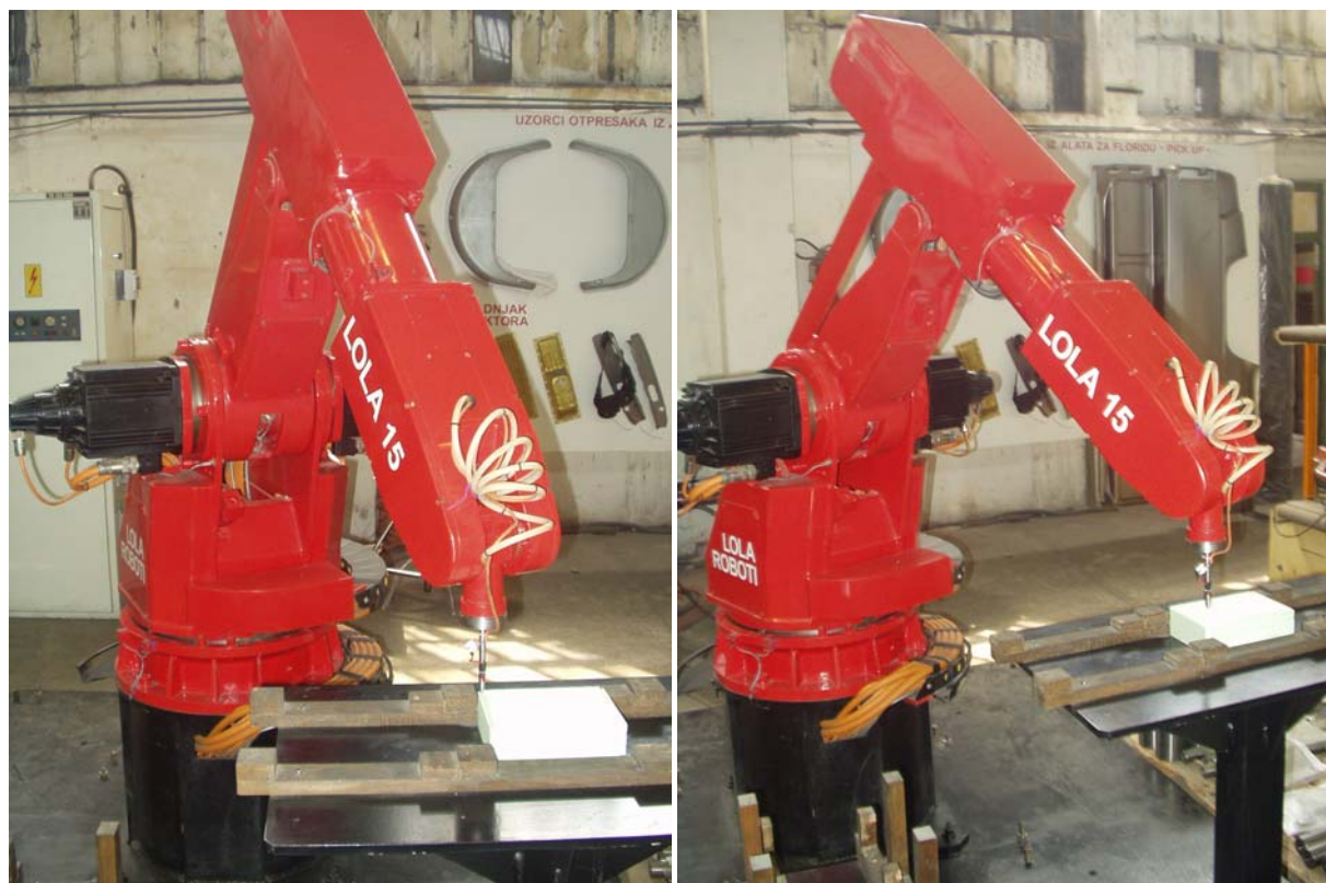
Slika 8. Eksperimentalna verifikacija korišćenjem robota LOLA 15 i simulatora elektrode
