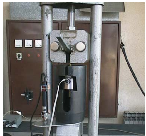
Slika 3 - Eksperimentalna oprema za eksperiment vučenja Slika 4 - Matrica i držač na priboru za zatezanje
