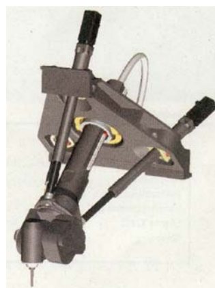
Sl. 4. Obradni centar GILDEMEISTER tip TriCentar sa paralelnom kinematikom za brzu orijentaciju i pozicioniranje radnog vretena
