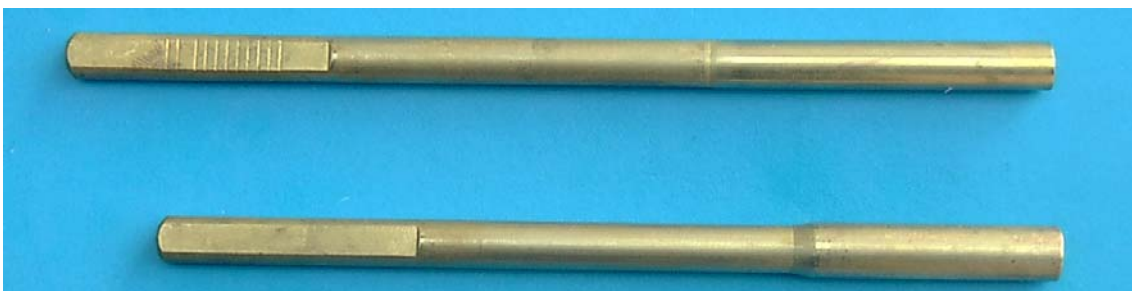
Slika 7 - Epruvete od mesinga, pre i nakon vučenja
