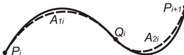
Slika 2.2 Aproksimacija krive kružnim lukovima
