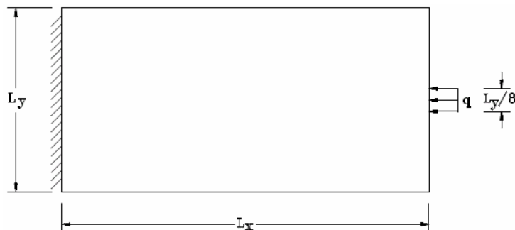
Slika 3. Konzola opterećena sopstvenom težinom i opterećenjem na slobodnom kraju
