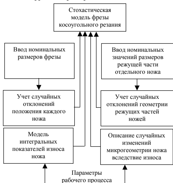
Рис. 2. Структура блока стохастической модели фрезы
