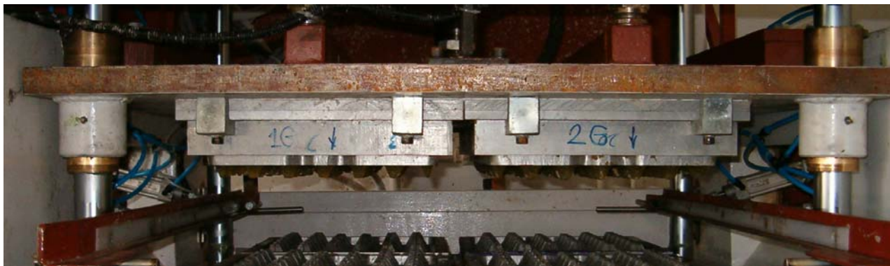
Slika 4. Srednja ploča sa transfer alatima u sklopu forming mašine
