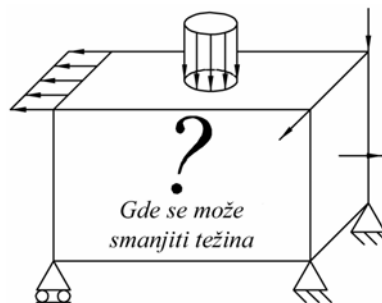
Slika 1. Oblik konstrukcije je teško predvideti; višestruka opterećenja po tipu i mestu dejstva, različiti tipovi oslonaca - kako doći do izgleda nove konstrukcije? [2]
