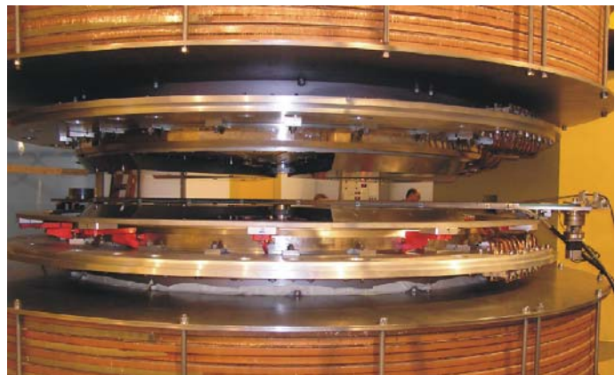
Слика 1. Циклотрон VINCY, схематски прикз и фотографија магнетних полова
