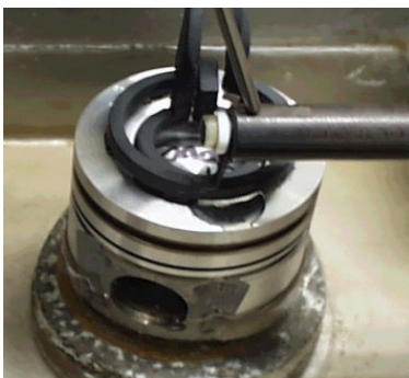
Slika 3. – Ispitivanje otpornosti klipa na nagle promene temperature (termo šokove).
