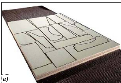
Slika 1. a) Primer krojenja složenih oblika na mašinama tipa obradnih centara, b) najčešći oblik konstrukcije nosača alata sa smerovima kretanja glavnog alata i predrezača na mašinama tipa raskrajača, c) primer sečenja sa rezovima preko čitave tekuće širine/dužine table (tzv. giljotina rezovi)
