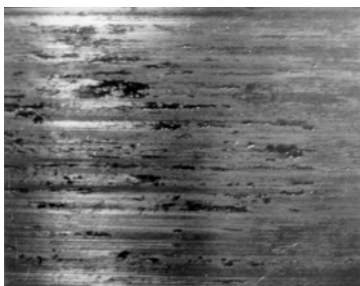
Сл. 2. Изглед површине рукавца пре и после извођења стругања и суперфиниша
