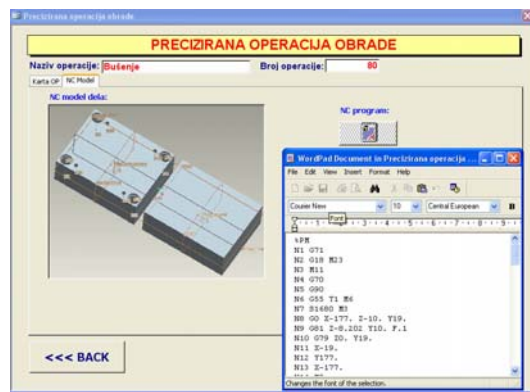
Slika 6b. Izvod iz programskog rešenja za definisanje konkretne operacije obrade i generisanje upravljačkog programa [4]
