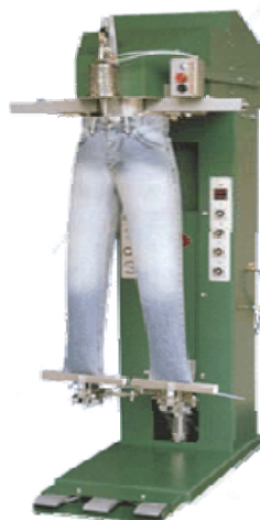
Slika 5. Automatska mašina za peglanje nogavica sa mikroprocesorom [5]
