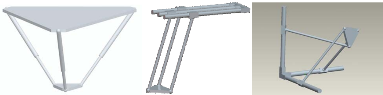
Slika 2. Karakteristični tipovi paralelnih mehanizama
