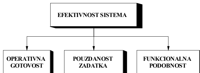
Slika 4: Efektivnost sistema u funkciji: operativne gotovosti, pouzdanosti i funkcionalne podobnosti
