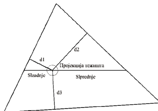
Слика 2. Резерве стабилности и полигон ослањања
