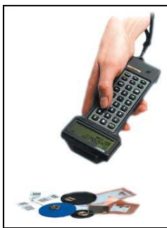
Slika 1. Komunikacija između RFID čitača i taga
