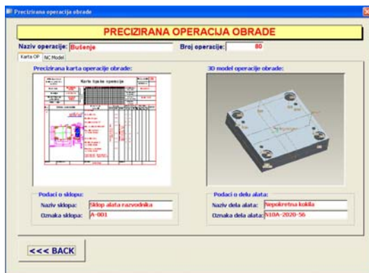
Slika 6b. Izvod iz programskog rešenja za definisanje konkretne operacije obrade i generisanje upravljačkog programa [4]
