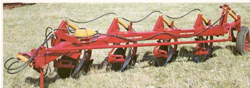
Slika 2: Višebrazdni raoni plug sa hidrauličkim sistemom za obezbeđenje od preopterećenja
