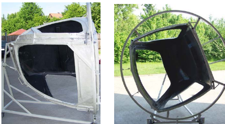
a) b) Slika 6. Kompozitni kalup za izradu kabine
