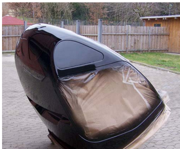
Slika 5. Pozitiv kabine pripremljen za izradu kompozitnog kalupa
