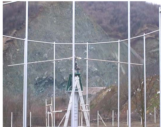
Slika 4: Šema pogona rotora vazduhom sabijenim usled rotacije i slika sa testa u Laboratoriji za mlaznu propulziju Mašinskog fakulteta u Beogradu
