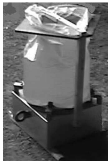
Slika 2. Alat za oblikovanje sa vodenim rezervoarom
