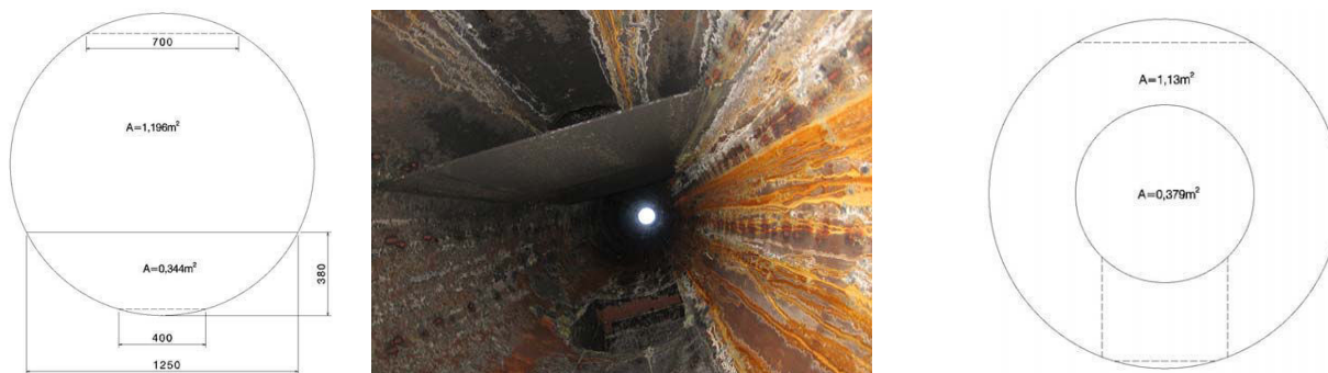
Slika 2: Skica i fotografija prethodnog stanja i skica novog rešenja
