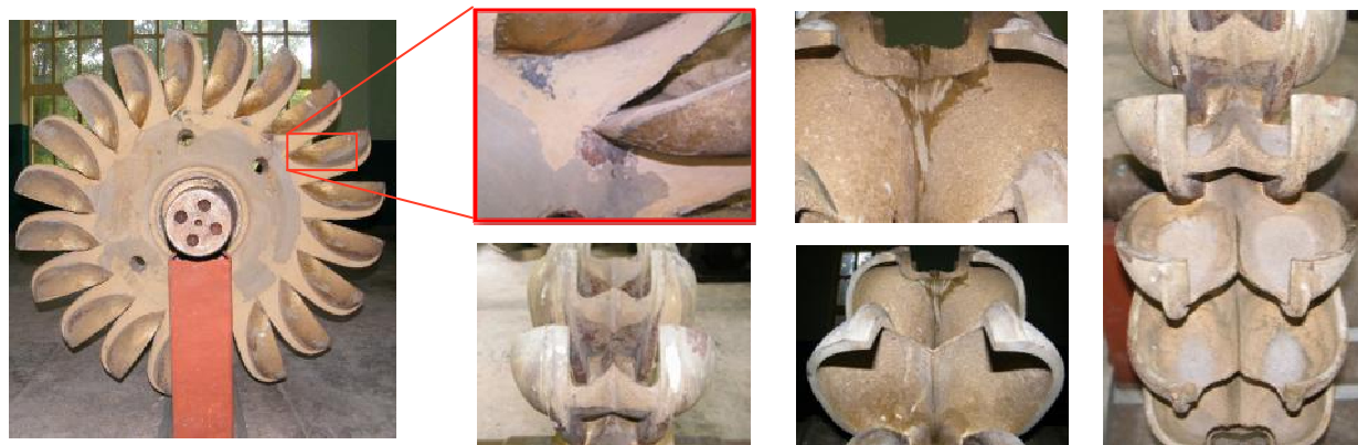
Slika 2. Radno kolo iz 1952. godine sa karakterističnim oštećenjima u korenu lopatice, na sečici i na košu
