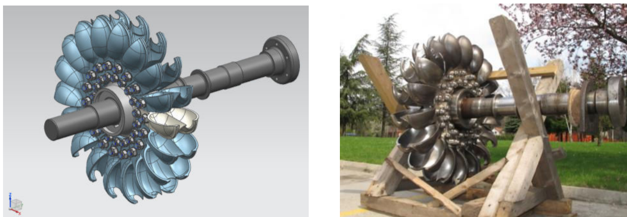
Slika 8. 3D CAD model sklopa radnog kola i napravljeno radno kolo peltonove turbine
