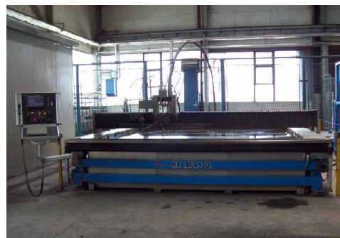
Slika 11. Segment upravljačkog programa i izgled mašine za obradu vodenim mlazom [4]
