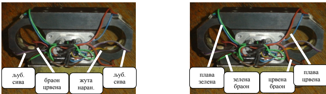
Слика 2.5: Положај мерних трака на површинама сензора, боје проводника и фотографије реализованог ожичења
