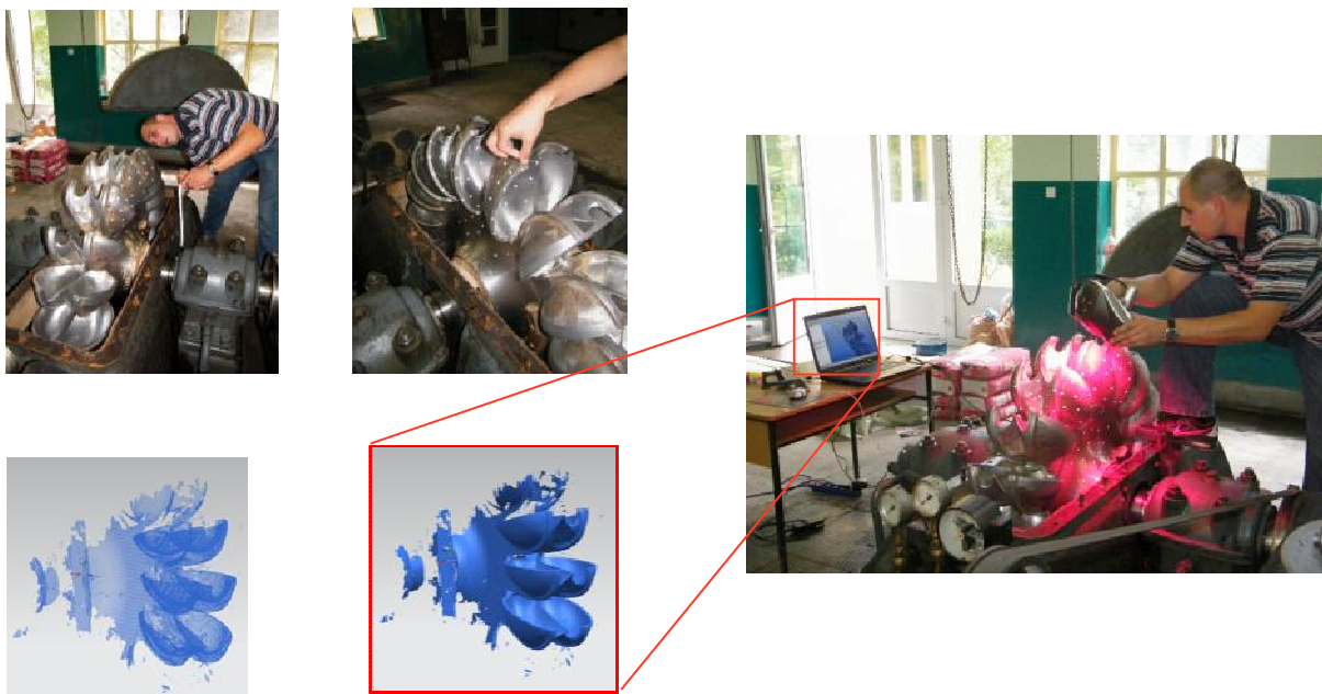
Slika 5. Proces digitalizacije radnog kola peltonove turbine
