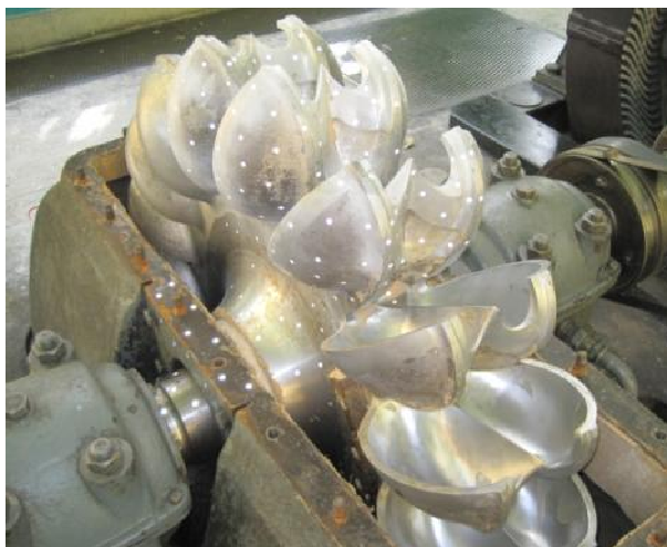
Slika 3. Radno kolo iz 1978. godine tip Pelton P1 0.9/120, Litostroj
