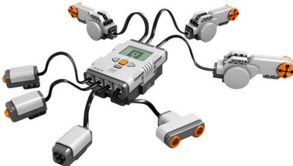
Слика 2.4. Блокови и управљачка јединица LEGO Mindstorms NXT пакета
