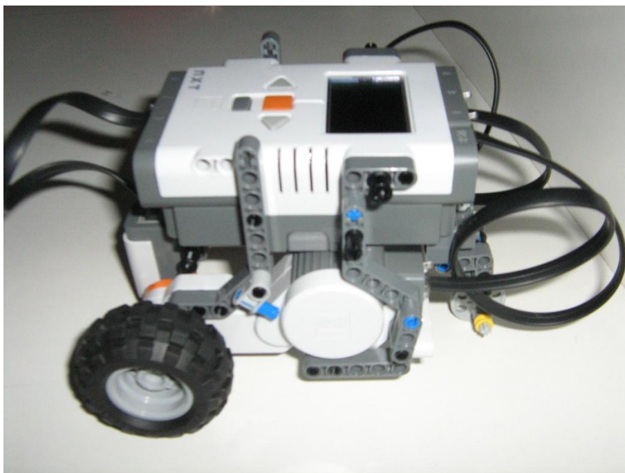
Слика 5.9: Приказ положаја управљачке јединице и оптичког сензора
