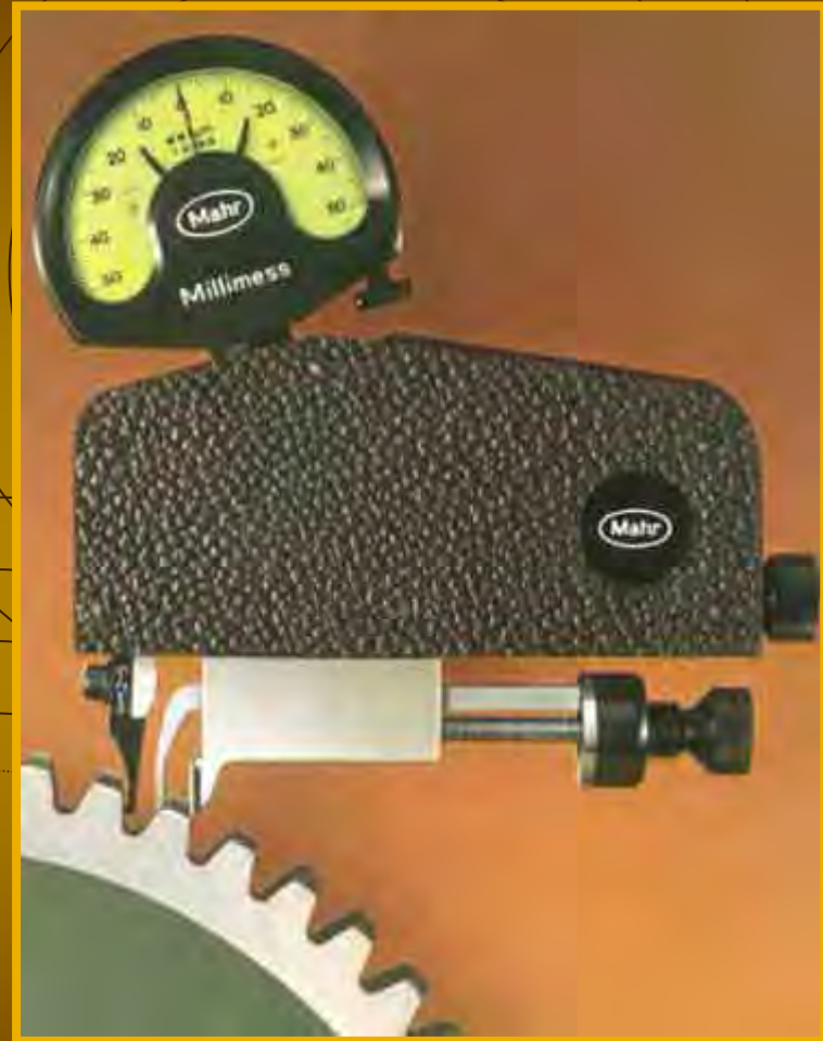
Provera tačnosti zupčanika pomoću komparatora
