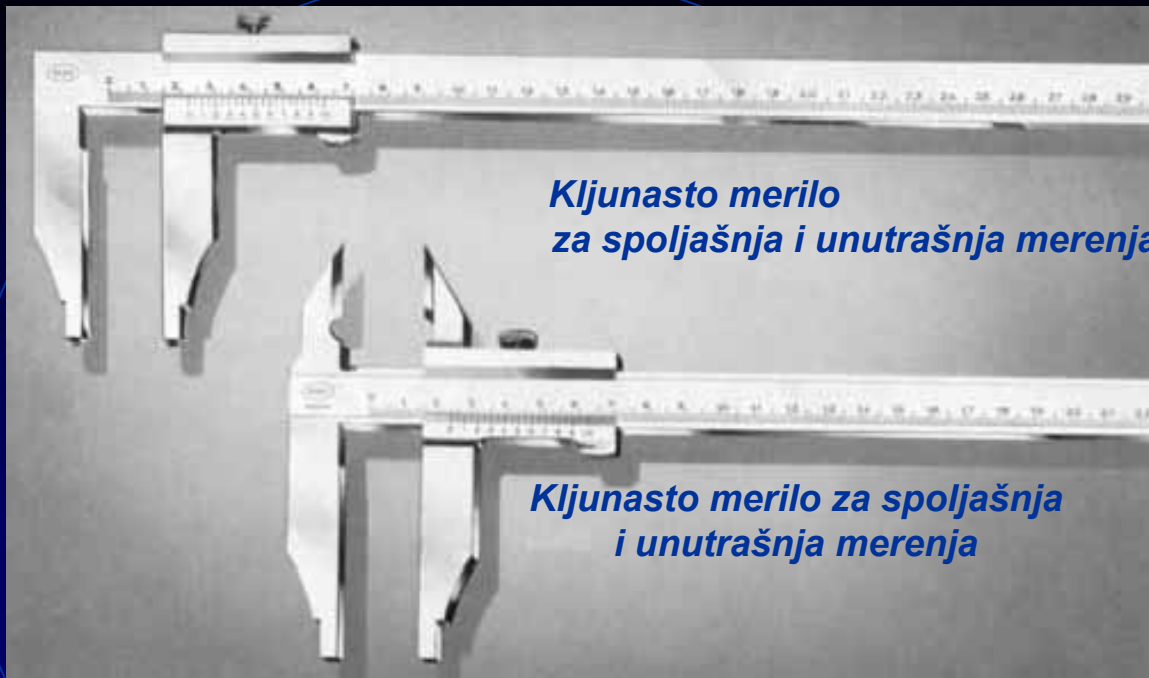
Kljunasto merilo sa nonijusom za merenje međuosnog rastojanja dva otvora
