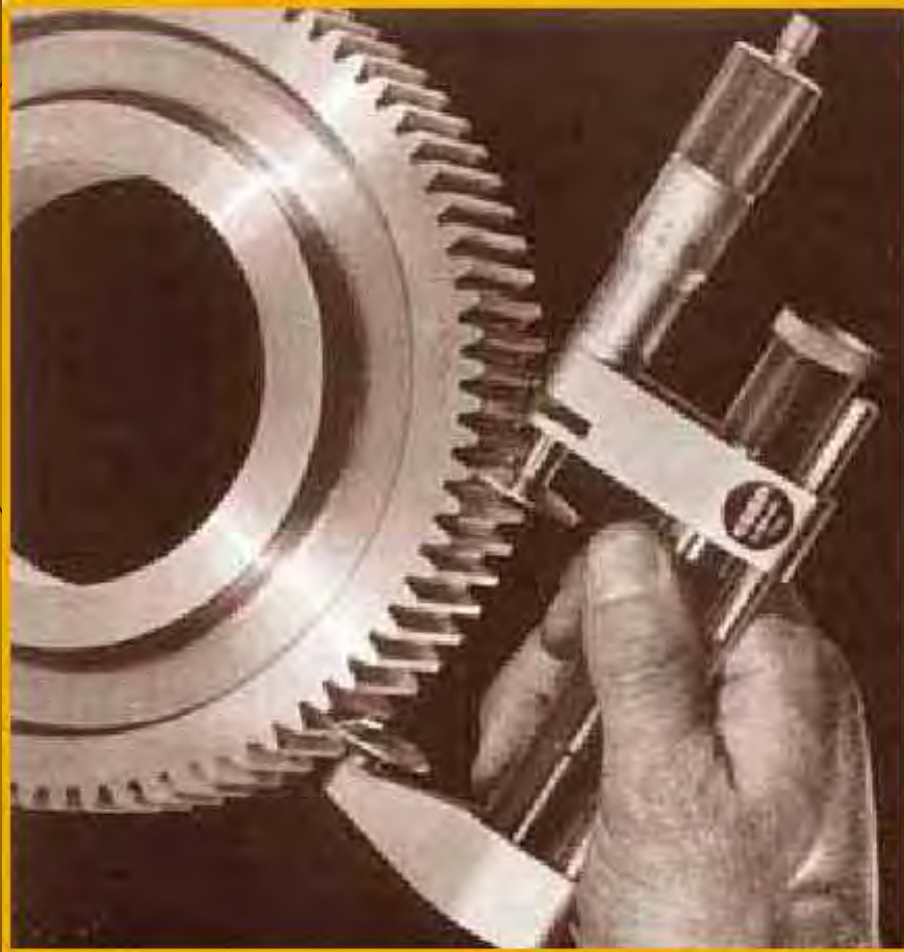
Merenje koraka zupčanika mikrometrom sa tanjirastim naslonim površinama
