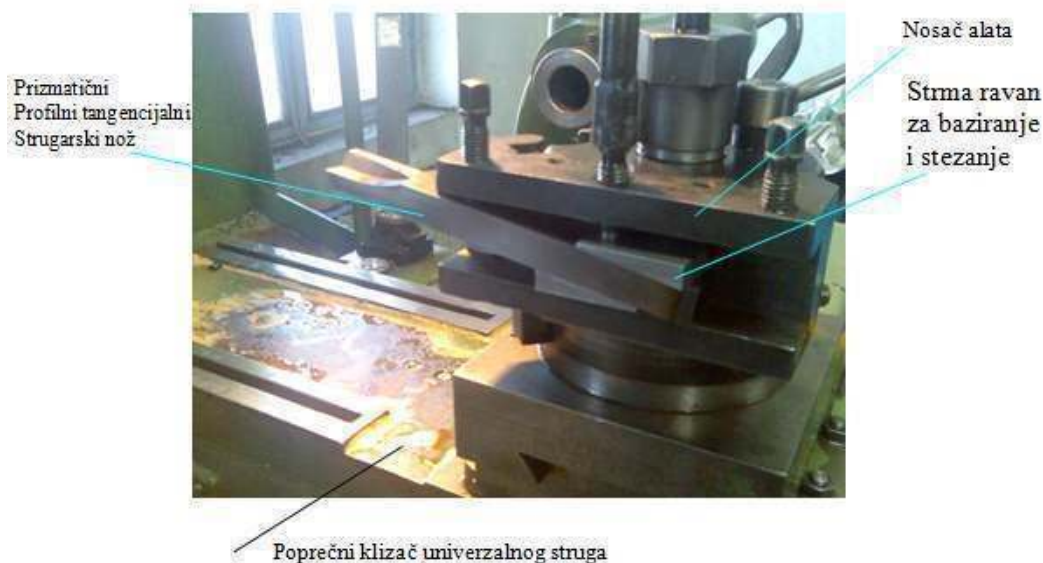
Slika 22. Plan stezanja profilnog noža u nosač alata na univerzalnom strugu
