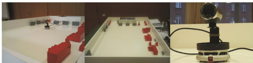
Слика 3 Мобилни робот Khepera II са WEB камером у лабораторијском моделу технолошког окружења.
