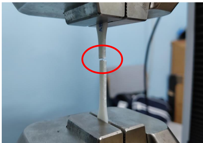
Slika 1. Primer uzorka pozicioniranog u čeljusti kidalice
