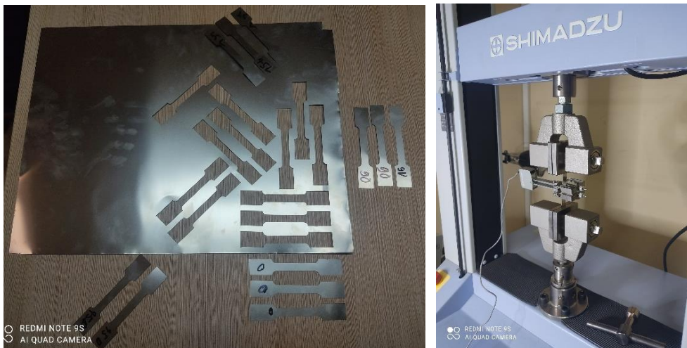
Slika 6. Epruvete isečene pod različitim uglovima za test na kidalici
