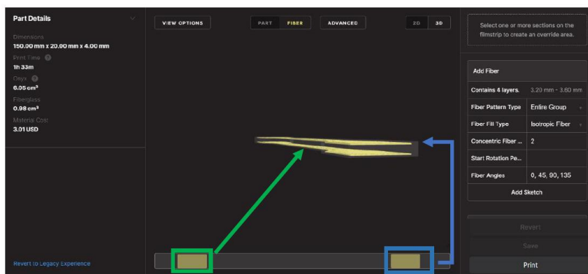
Slika 5. Prikaz osam slojeva ojačanja u vidu fiberglasa
