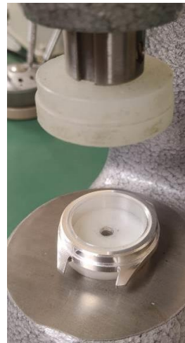
4.5 - Убацивање стакла помоћу мануелне пресе
