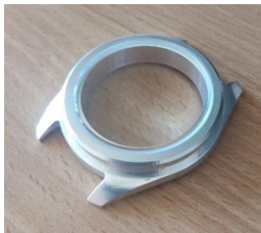
4.2 - Изглед ручног сата након обраде и постављања одговарајућег стакла
