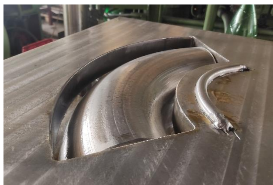
Slika 13. Sklop alata i prikaz držača lima sa kočecim rebrom na kojoj se postavlja pripremak
