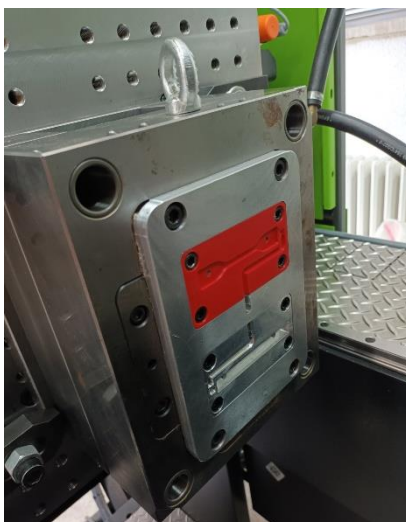
Slika 1. Umetak za brizganje epruvete izrađen od ABS-X filameta
