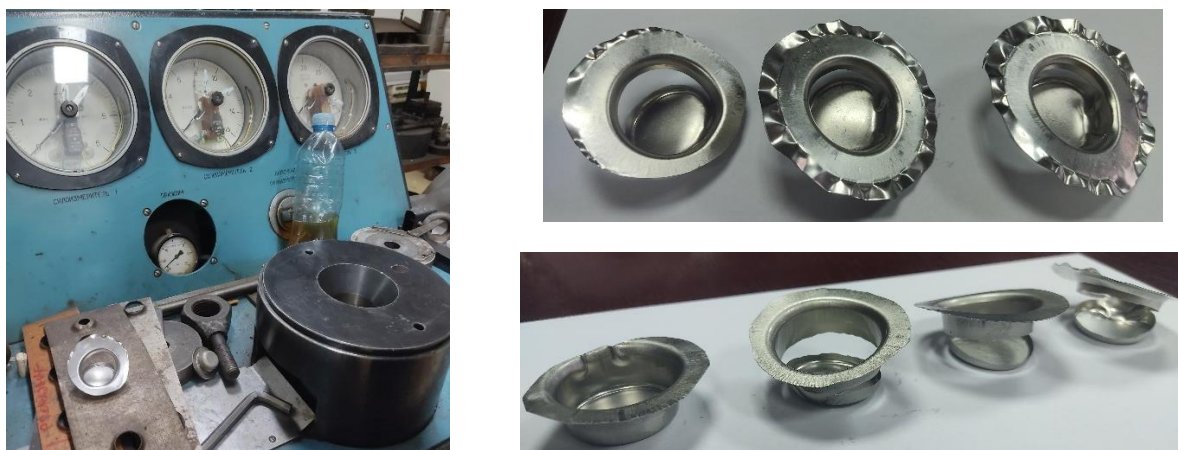
Slika 4. Test izvlačenja za određivanje minimalnog odnosa izvlačenja
