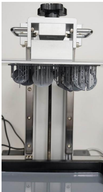
3.1- Модели након завршеног процеса 3D штампе
