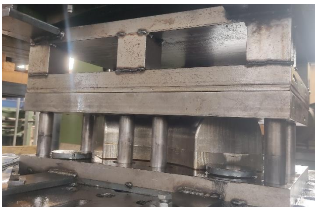
Slika 13. Sklop alata i prikaz držača lima sa kočecim rebrom na kojoj se postavlja pripremak
