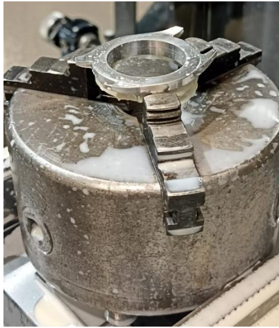
4.4 – Завршена машинска обрада везана за друго стезање
