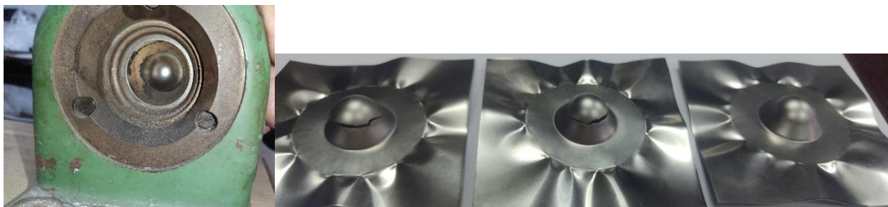
Slika 5. Rezultati testa razvlačenja do pojave loma
