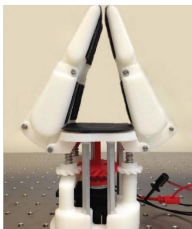
Slika 9. Predložena konstrukcija šake, napravljen prototip i 2D prikaz principa za dekuplovanje [18]
