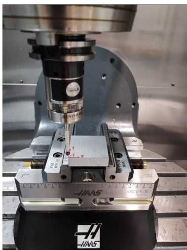
4.2 - Постављање припремка и налажење нулте тачке
