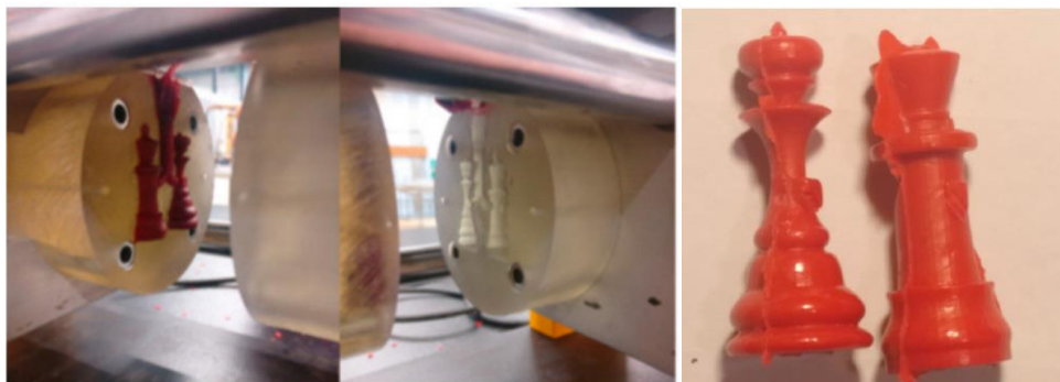
Slika 2. Umetak izrađen SLA tehnologijom a) i pojava curenja materijala na spoju alata [3]
