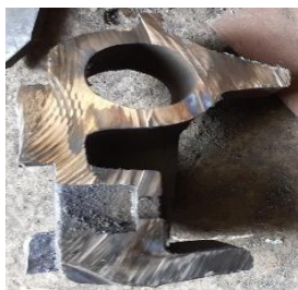
Slika 5. Članak presečen u karakterističnom preseku - potvrda da nema unutrašnjih grešaka
