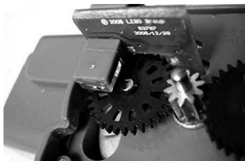
Слика 4.2.3: Сензор ротације сервомотора
