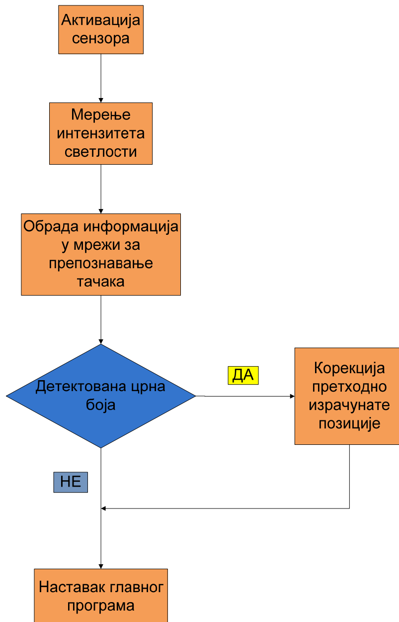
Слика 6.3.2 : Ток информација кроз модел за препознавање контролних тачака у окружењу робота
