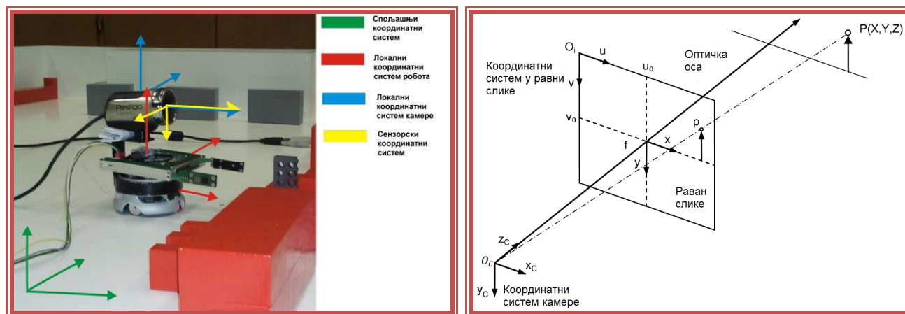
Глобални и локални координатни системи (лево) и модел камере (десно)
