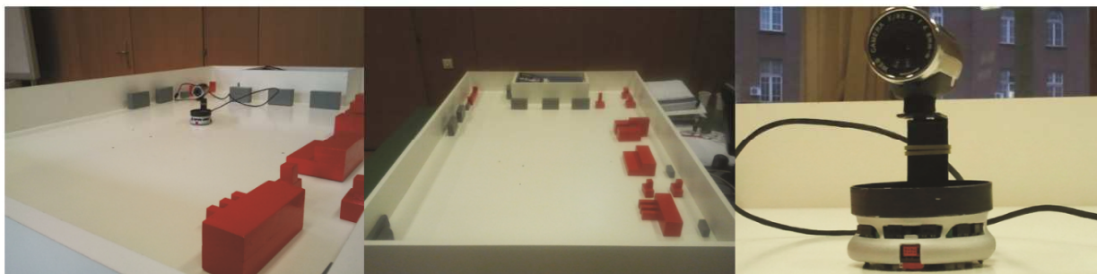
Мобилни робот Kheperall са WEB камером у лабораторијском моделу технолошког окружења
