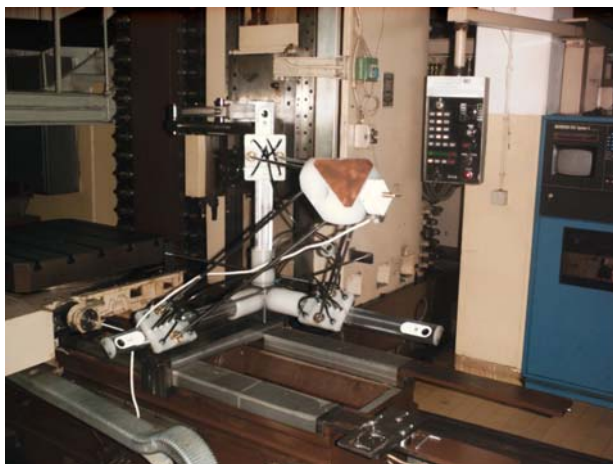
S1. Naša prva troosna mašina sa paralelnom kinematikom P3
