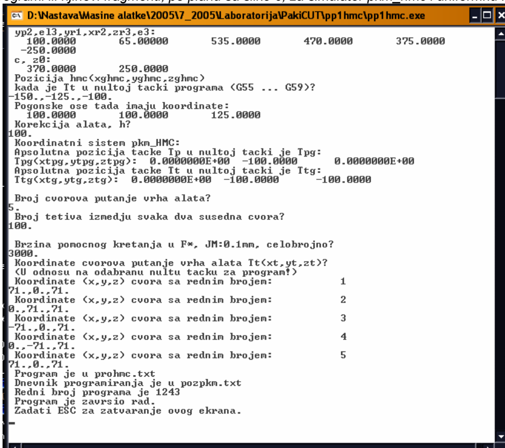
Slika 7. Programi ili njihovi fragmenti, po planu sa slike 6, za simulator pkm_hmc i uniformnu linearizaciju
