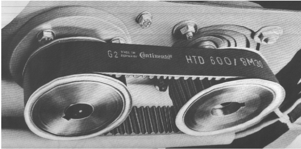
slika 4. Primer zupčastog kaišnog prenosnika kod mašine alatke
