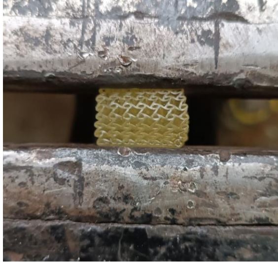
Слика 3.13 Ауксетичка структура оптерећена на притисак
