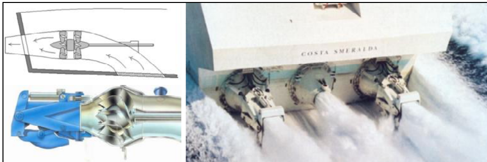
Слика 21 Водомлазни пропулзори за веће брзине
