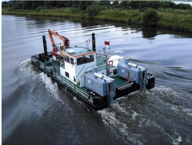
Слика 18 Кормиларско-пропулзивни уређаји са погонским моторима на палуби
