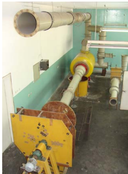
Сл.12. Постројење за испитивање енергетских карактеристика радијалних вентилатора
