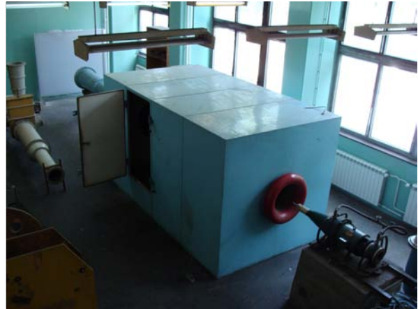
Сл.11. Постројење за испитивање енергетских карактеристика аксијалних вентилатора и вихорног струјања у дифузорима
