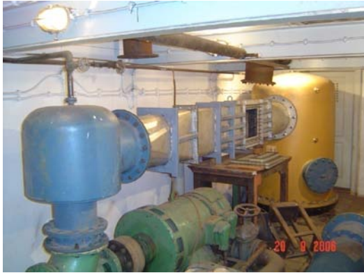
Сл.8. Постројење за изучавање кавитацијских појава у пумпама и на хидропрофилима са могућношћу визуализације кавитацијских појава
