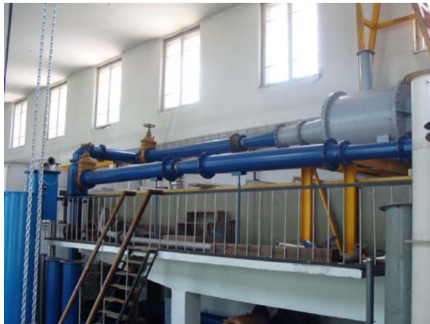
Сл.6. Постројење за испитивање енергетских и кавитацијских карактеристика модела турбина (Франсисових, Капланових, Цевних), малих хидроелектрана и хидромашинске опреме
