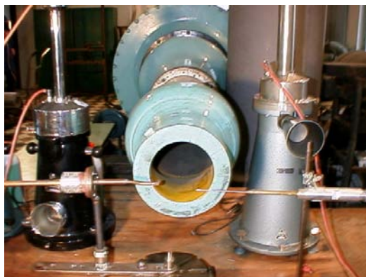
Сл.13. Постројење за баждарење сонди за мерење брзина и притисака
