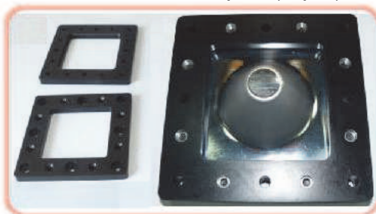
Слика 5.6 Коначна израда радне конструкције и прстена за стежање [2]
