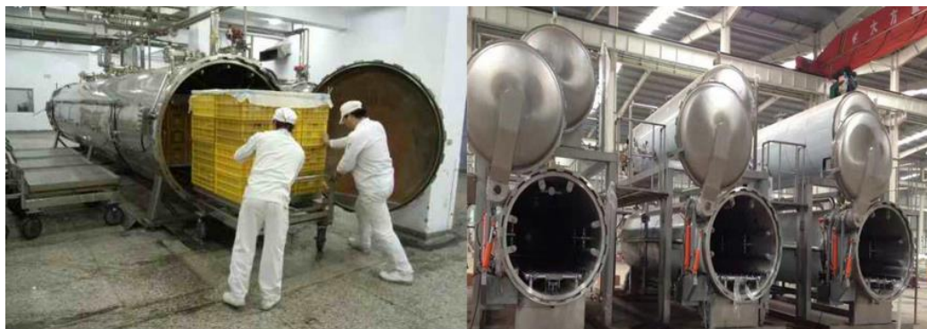
Слика 9. Илустрација реторти за термичку обраду прехранбених материјала
