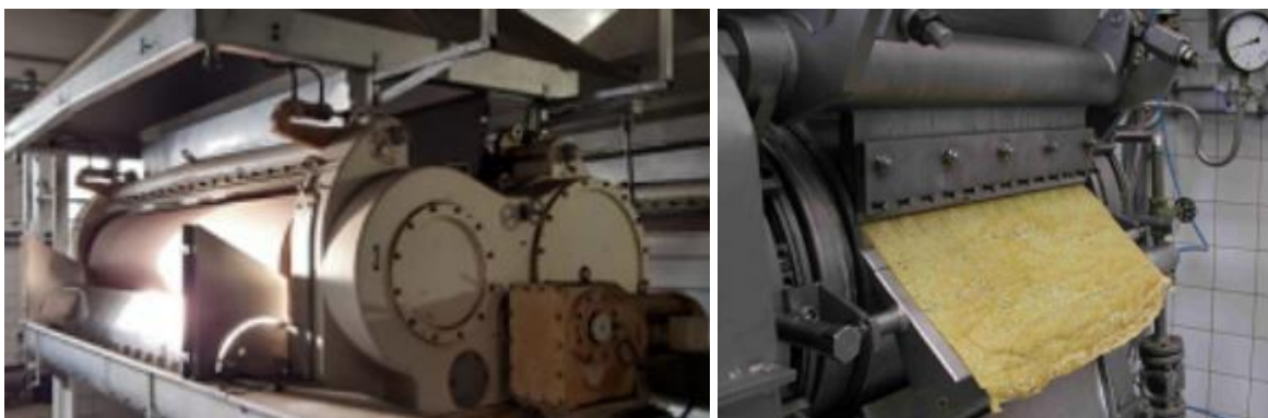
Слика 17. Илустрација добошасте сушаре (лево) и стругања материјала са добоша (десно)
