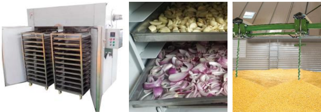
Слика 15. Илустрација коморне сушаре са материјалом на лесам (лево, средина) и коморне сушаре са зрнастим материјалом у гомили (десно)
