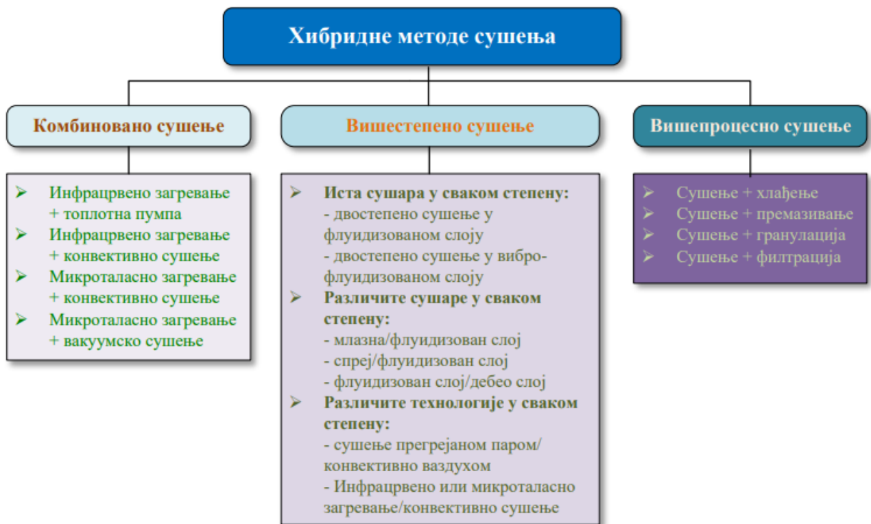
Слика 18. Класификација хибридних сушара које се најчешће срећу у пракси
