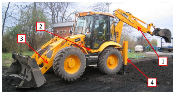
Slika 21. Univerzalni kopač-utovarivač (kombinovana mašina): 1 - zahvatni uređaj dubinske kašike, 2 - traktor, 3 - zahvatni uređaj utovarne kašike, 4 - nosač sa stabilizatorima uređaja dubinske kašike
